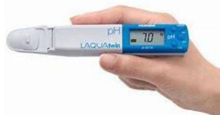
pHメーターともいう。主として水溶液中の希薄な水素イオン濃度を測定する計器。ガラス薄膜を水素イオン選択性膜とするガラス電極と照合電極とを組み合わせた電極を溶液中に浸し、両電極間の電位差を pH の値として指示する。
