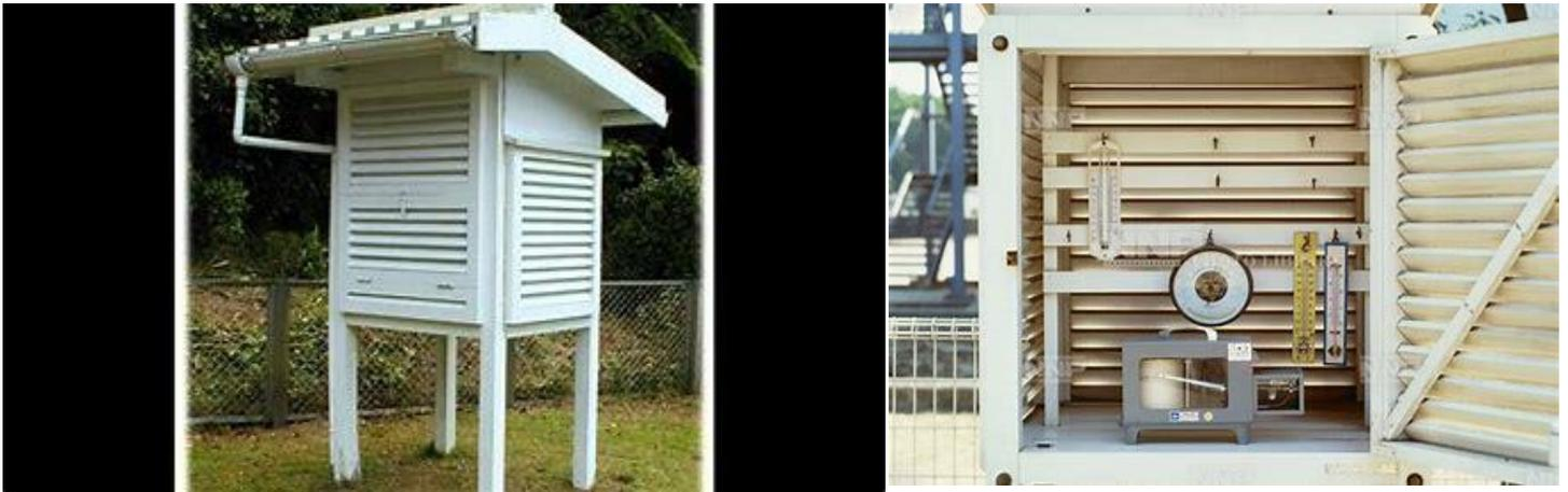
[気象観測](#)のために設置する[温度計](#)などの観測機器を日射から遮蔽するとともに雨や雪から保護するための装置（箱）<sup>[2]</sup>。百葉箱や[雨量計](#)などを設置した気象観測のための場所を「露場」という。
