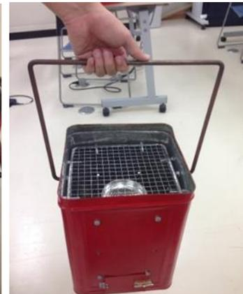
写真26 取手の取り付け
