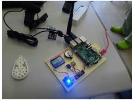
写真1 デモ機（基盤に気象センサーと定点カメラが接続されたもの）
